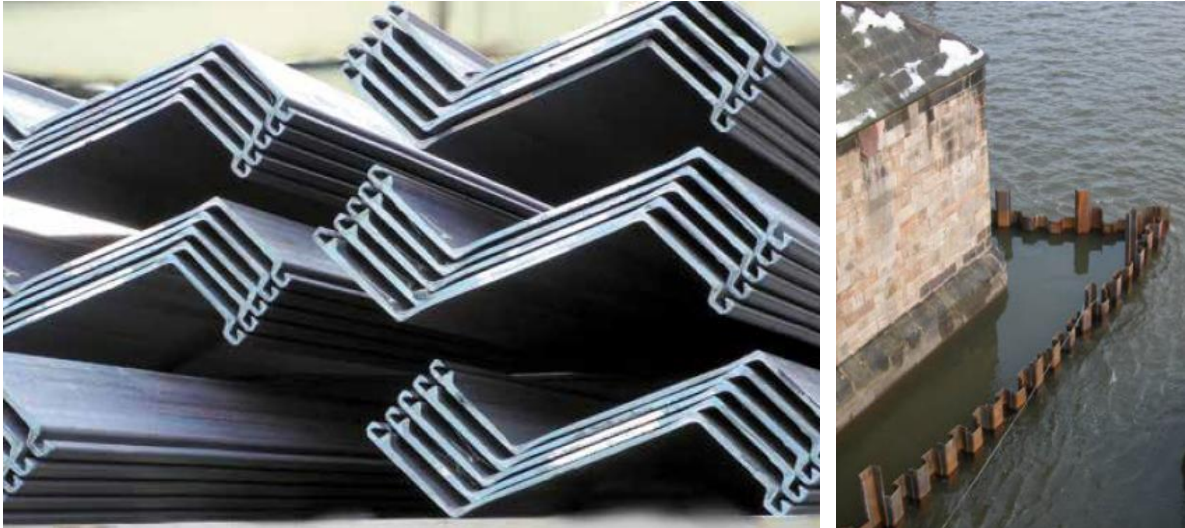
Fig.15 – Palancole e loro impiego nel consolidamento delle pile dei ponti in alveo
